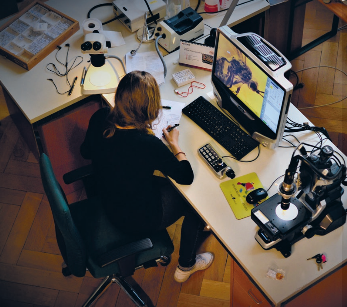
Alexandra Viertler untersucht eine in Baltischem Bernstein eingeschlossene Darwin-Wespe unter einem Keyence-Digitalmikroskop. Mit diesem lassen sich Aufnahmen von Objekten machen, die dann stark vergrössert auf einem Monitor angeschaut werden können. Das Objekt kann zudem aus verschiedenen Blickwinkeln betrachtet werden, was die präzise Beschreibung der neuen Art ermöglicht.
